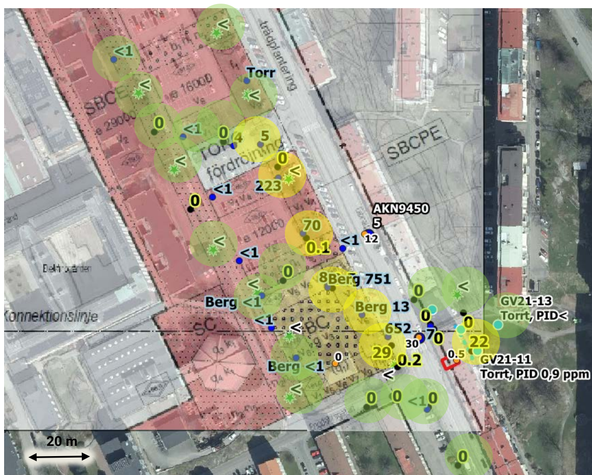
Figur 16. Sammanställning utförda undersökningar avseende grundvatten i jord, berg och trädskärnor på plankartan. Blått avser senaste provtagningen av grundvatten och summa klorerade lösningsmedel ( \mu\text{g/l} ). Gult är porgasmätningar med PID alt. kolrör i lab "kol" ( \text{mg/m}^3 ). Trädskärnor är grönmarkerade. Gröna ringar markerar inga halter och gula ringar markerar spårhalter.
