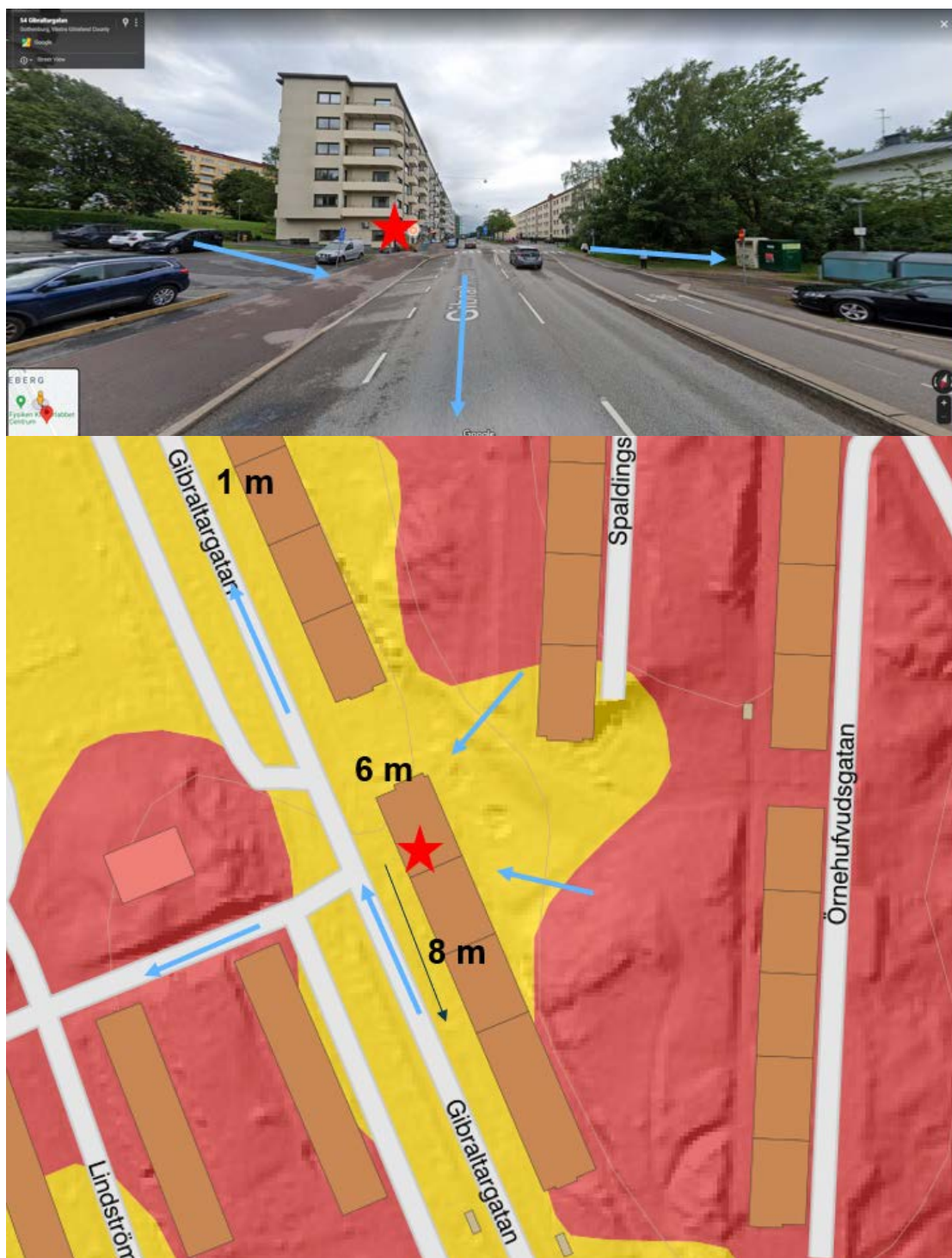
Figur 9. Lera (gult) och berg (rött). Djup till berg anges i svarta siffror. Grundvattnets troliga strömningsriktning markeras med blå pilar. Vid fastigheten kan ytavrinning även ske mot söder, se svart pil.
