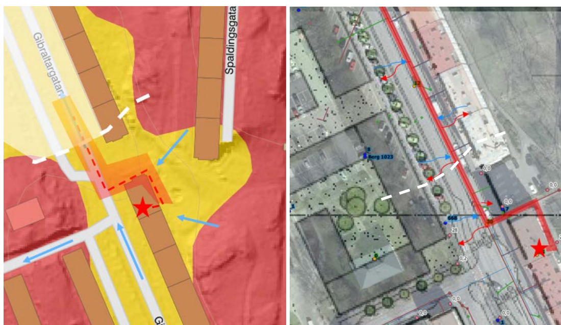
Figur 11. Trolig föroreningssituation. Förorenat vatten från kombiledningen förväntas ha kontaminerat grundvatten i jord och ytligt berg längs ledningen, se röd markering.
