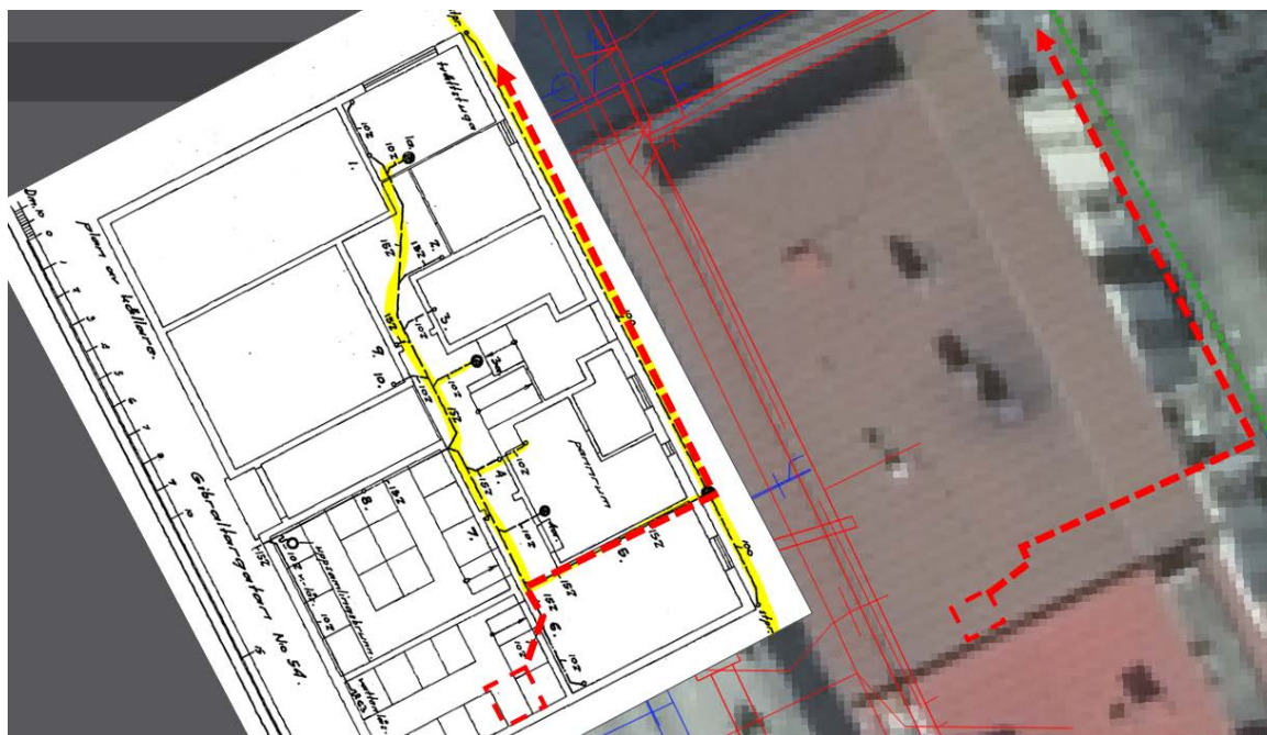
Figur 7. Brunnar och ledningar. Sannolikt har kontaktvatten från tvätten släppts till brunn och vidare i rödmarkerad ledning.
